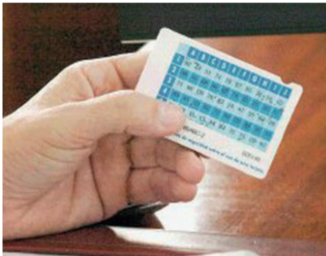
Figura 6.14. Clave dinámica que el BCR hizo obligatoria en el 2008, que funciona como un segundo factor de autenticación
